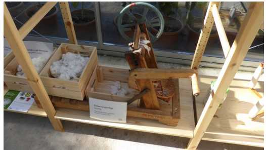
Entkernungsanlage zur Trennung von Samen u. Fasern
