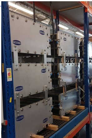
Mehrere Stacks im Regal und „Verrohrung“ der Module auf der Rückseite
