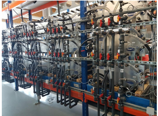
Mehrere Stacks im Regal und „Verrohrung“ der Module auf der Rückseite
