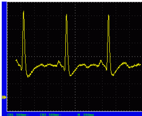
Abbildung 15: Ausgangssignal des fertigen EKG-Verstärkers
