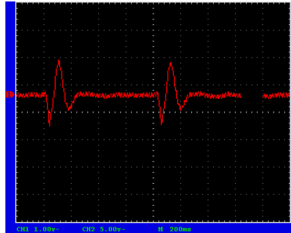
Abbildung 14: Ausgang der Filterschaltung mit Tiefpässen
