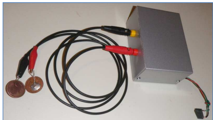
Abbildung 16: EKG-Verstärker in Metallgehäuse mit Messleitungen und Elektroden
